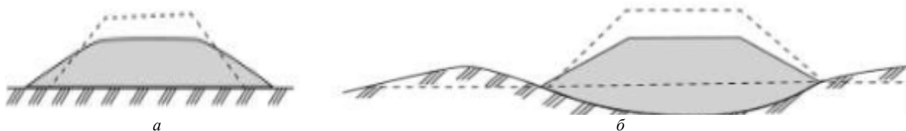
1-расм. Мустаҳкам ва бўш асосга эга йўл кўтарма деформацияси: a – мустаҳкам асос; б – бўш асос
