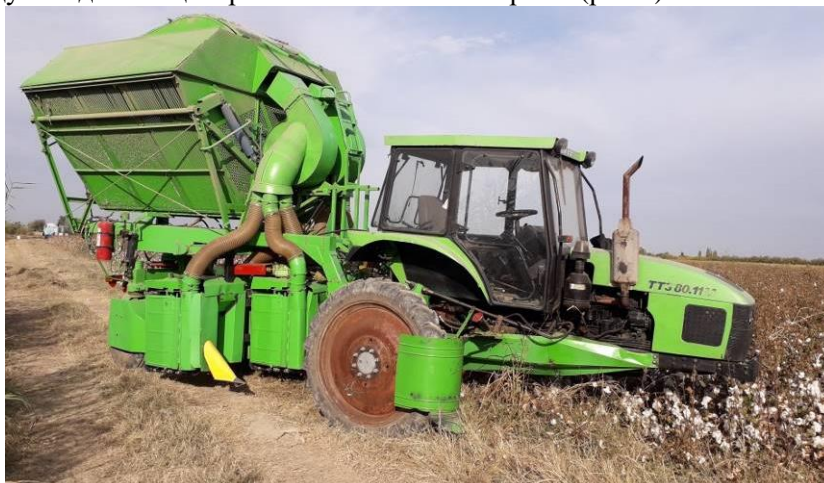
Рис. 4. Хлопкоуборочная машина МХ-2,4, оснащенная усовершенствованными воздуховодами и конструкциями центробежного вентилятора
